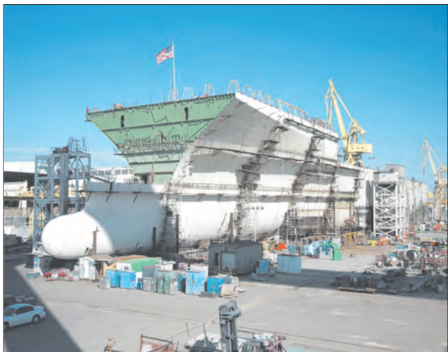
Секционная сборка универсального десантного корабля типа «Америка»
