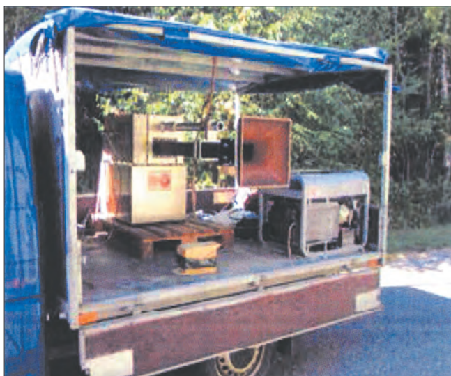
Испытания источника высокомощного СВЧ-излучения
