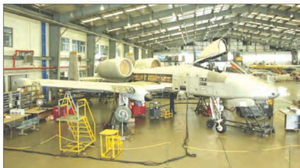
Модернизация американских штурмовиков «Тандерболт» на заводе компании «Корея эрлайнс»
