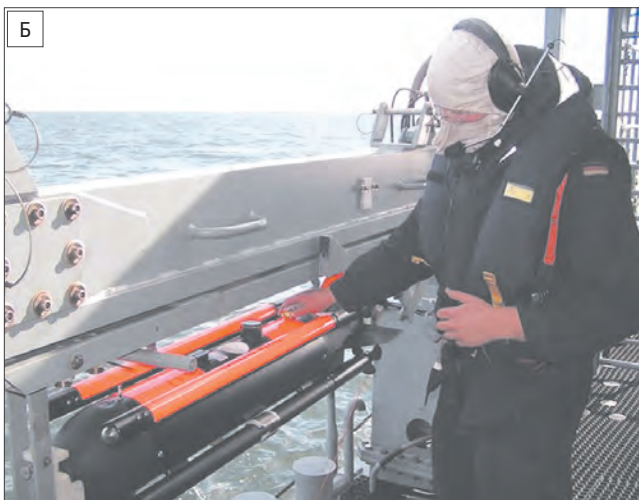
Внешний вид аппарата «Си Фокс» в контейнере хранения (А) и устройстве спуска на воду (Б)
