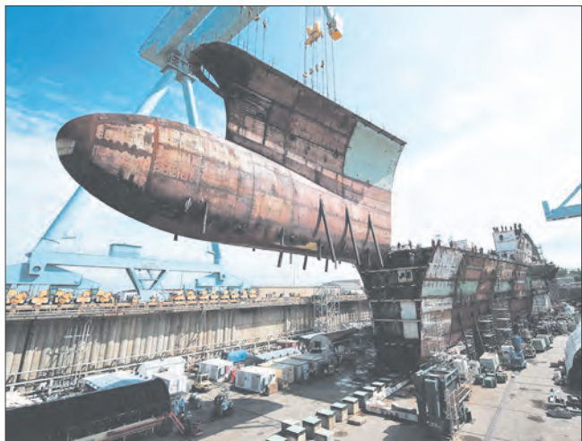
Секционная сборка авианосца «Джеральд Форд»
