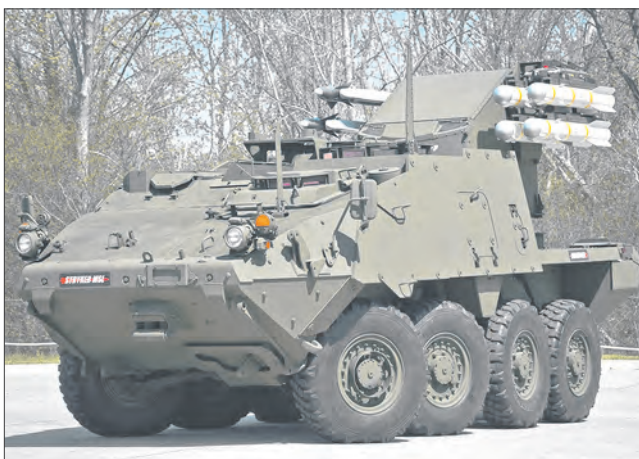
Новая модификация БМ «Страйкер» (мод. Mobile SHORAD Launcher) вооружена ПТУР AGM-114 «Хеллфайр» и ЗУР AIM-9
