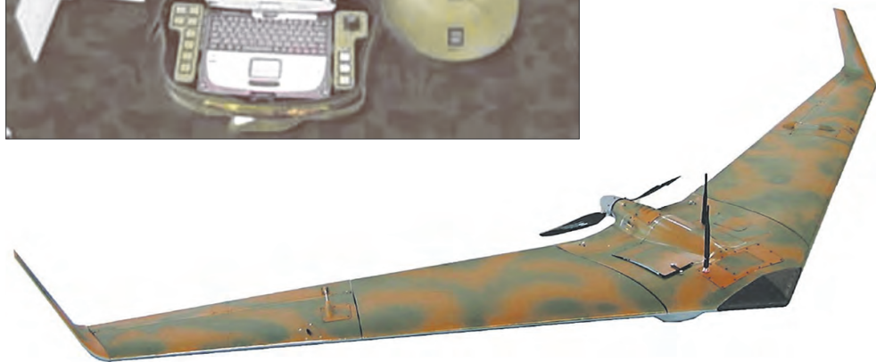
Беспилотный летательный аппарат «Стрикс-С» и комплект с ним в походном положении
