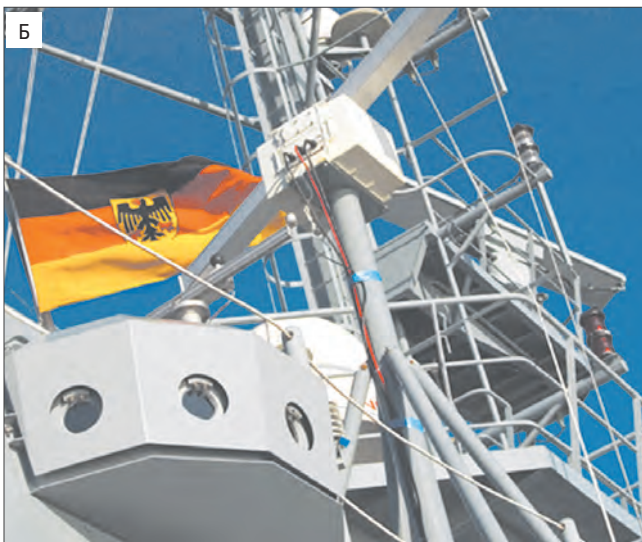
Расположение (А) и внешний вид (Б) оптоэлектронных средств обзора системы «Симоне»
