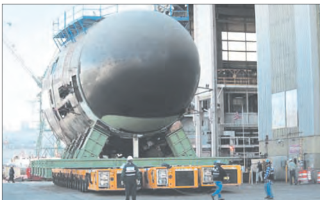
Доставка секции ПЛА типа «Виргиния» на сборочную площадку
