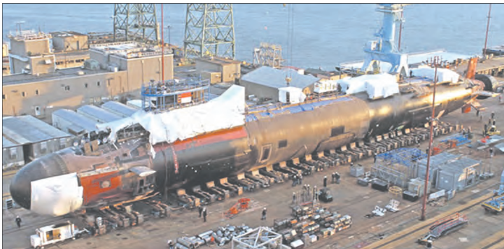
Строительство атомной многоцелевой подводной лодки типа «Виргиния»
