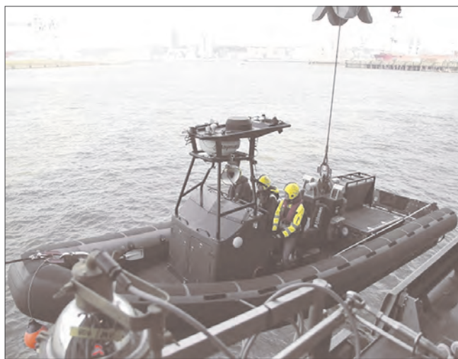
Спуск с борта корабля надувной лодки с жестким корпусом при проведении ходовых испытаний фрегата типа «Баден-Вюртемберг»
