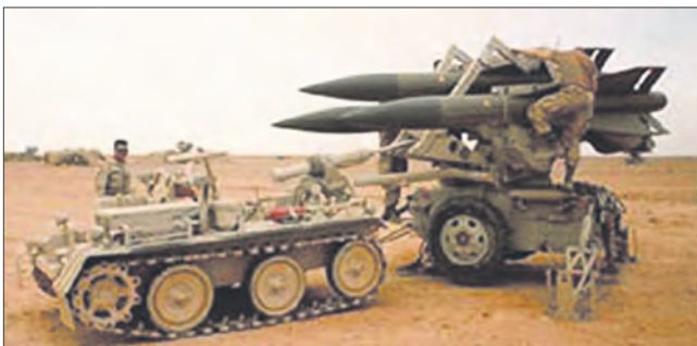
Внешний вид пусковой установки и транспортно-заряжающей машины ЗРК «Усовершенствованный Хок»
