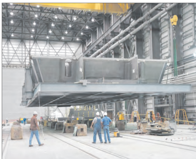
Узловая сборка эсминца типа «О. Бёрк»
