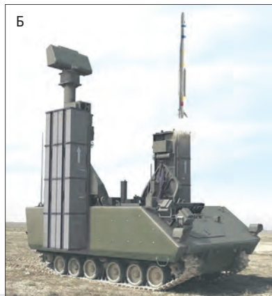
Внешний вид пусковых установок ЗРК: А) средней дальности «Хисар-О»; Б) ближнего действия «Хисар-А»
