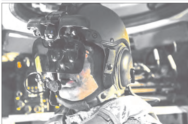
Нашлемная система дополненной реальности кругового обзора «Айрон Вижн» для экипажей боевых машин
