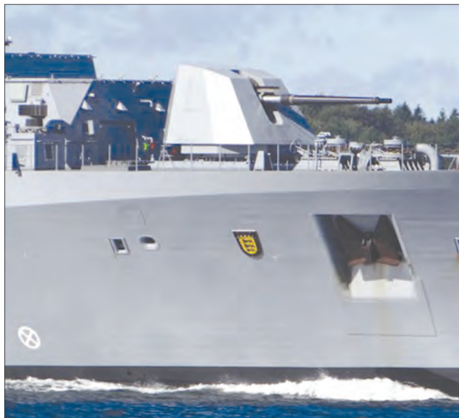
127-мм артиллерийская установка производства фирмы «ОТО Мелара»
